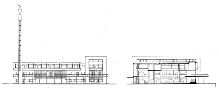
12. kép. Bardon Alfréd és ifj. Dávid Károly: „Yelken”, vagyis vitorla jellegű pályatervének tengerpart felőli homlokzata és keresztmetszete. A metszeten a tengerpart a jobb oldalon található. ( Mimar. Vol. 7. (1937.) No. 2. sz. 45., Györgyi Hültl-Irsy-Kozma 5.)
